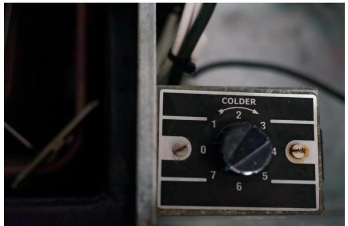
Vérifier le niveau de glace de temps en temps. La glace peut se former plus ou moins rapidement. Quand le niveau de glace est bon, pensez impérativement à baisser le thermostat de la tireuse d'un cran : passer à 6 quand le maximum est de 7, et passer à 7 quand le maximum est de 9. **Si vous ne baissez pas, le glaçon continue à se former sans arrêt et gèle tous les serpentins.** Une fois le thermostat baissé, vous pouvez commencer à tirer la bière.
