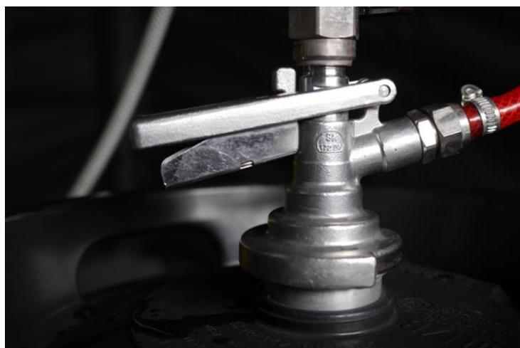
Ouvrir la vanne de la tête de soutirage (elle doit être abaissée vers le bas) pour que la bière remonte vers la tireuse.
